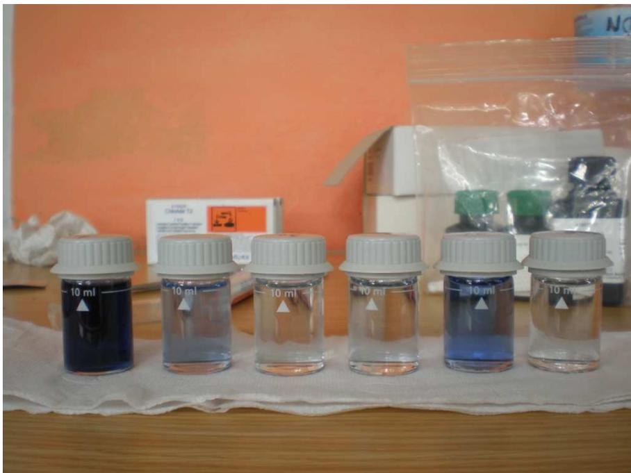
**Foto 14.** Resultado de un análisis de fosfato.
