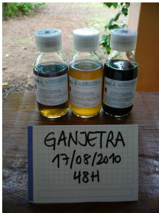
**Foto 17.** Resultados del análisis de enterococos y estreptococos, donde se observan distintas categorías de concentración relativa según la intensidad de color.
